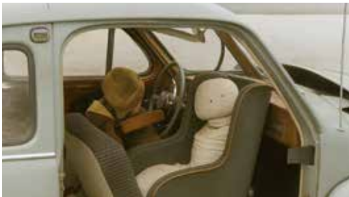
1964 - prototype autostoeltje met testpoppen
